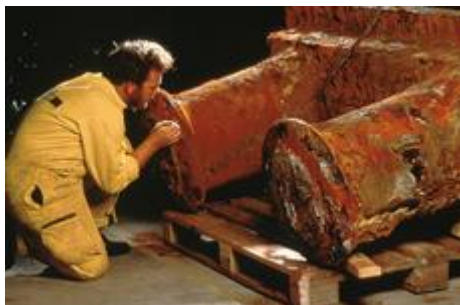
Restauration d'une bitte d'amarrage qui en 1912 était fixée sur le pont du Titanic
