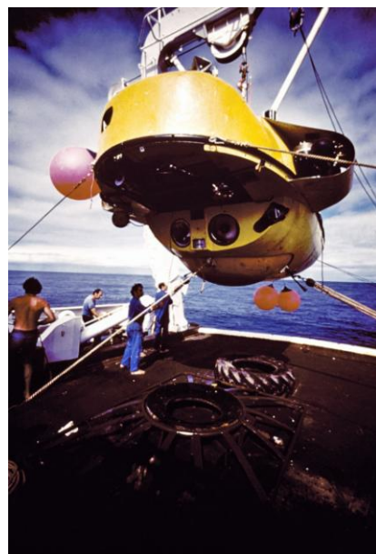
Cyana capable de descendre à 3 000 mètres de profondeur.
